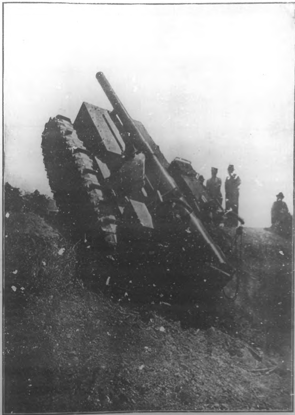
Un nuevo armamento adoptado recientemente por la artillería norteamericana. Consiste en un cañón de 6 pulgadas montado sobre un tractor.
